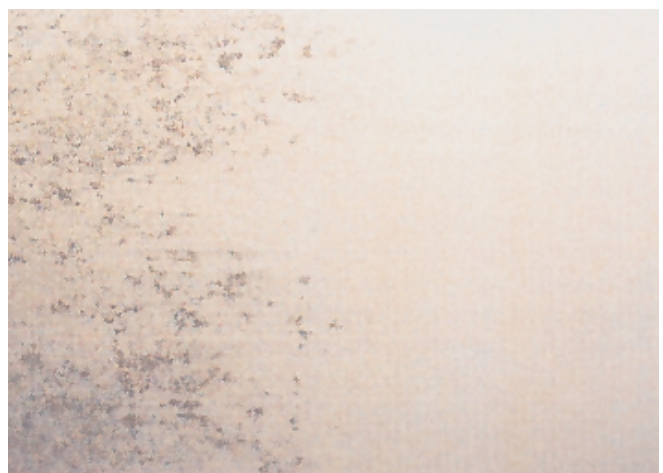
Figura 10 Aspetto di un pannello verniciato dopo un anno di esposizione in Florida. A destra la parte pulita
